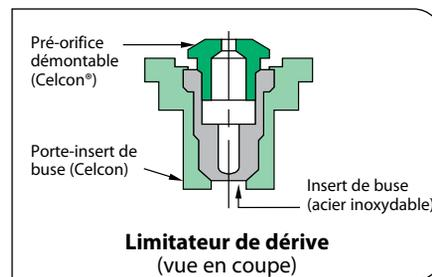
**Remarque :** En raison de sa conception de pré-orifice, cette buse n'est pas compatible avec le filtre de buse à antigouttes 4193A.
